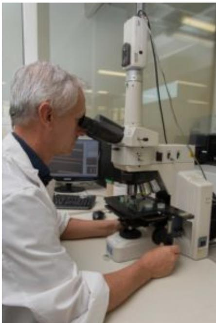
Dopo il montaggio dei componenti, la scheda assemblata viene sottoposta a un'attenta ispezione visiva e, in alcuni casi, a test automatici per garantire che tutti i componenti siano stati saldati correttamente e che non ci siano cortocircuiti o difetti di produzione.
